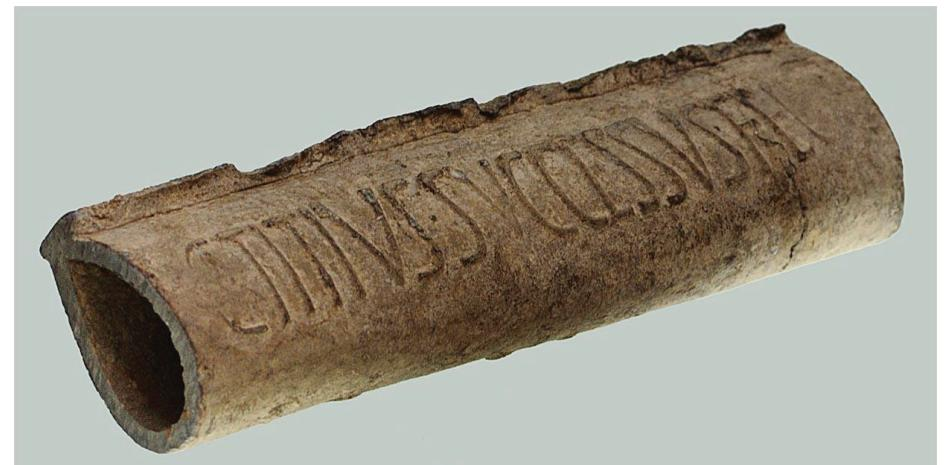
Un tubo (fistola) di un sistema di approvvigionamento idrico con il marchio del produttore
