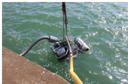
Figura 14 – Robot subacqueo con pompa a bordo
