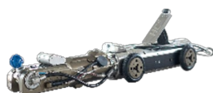
Figura 9 – Robot per pulizia superfici
