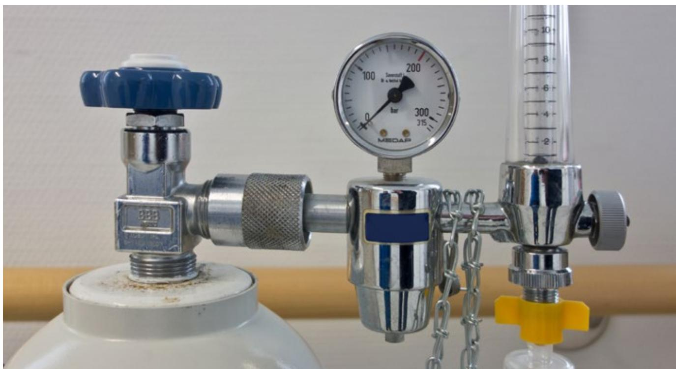
In Italia i requisiti della norma ISO 9170-1 trovano ulteriore applicazione nella norma UNI 9507, che li recepisce, determinando forme e dimensioni delle parti e associando a ciascun gas considerato il proprio codice colore univoco, riportato sulla ghiera esterna della connessione gas-specifica ben in vista all'utilizzatore come ulteriore richiamo alla sicurezza.
