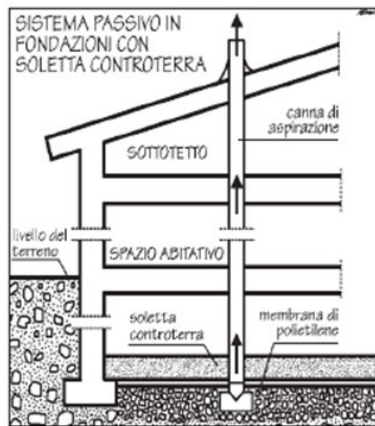
Fig.1 – Sistema passivo in fondazioni con soletta controterra;
